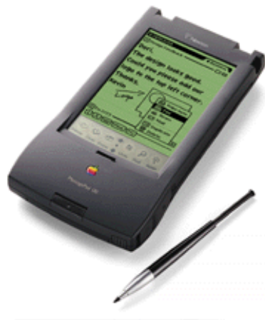
Fig. 3 - The Apple Newton MessagePad PDA.
